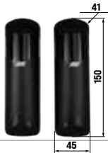
ACG8046 NOVA инфракрасный диапазон сигнала = 15 ÷ 40 м - 180° оптика синхронность до 4 пар управляет 2 фронтами по/нс 8,2 кОм IP 44 - 12/24V ac/dc
