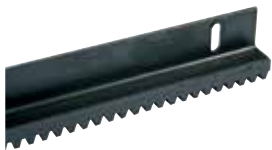
ACG9050 РЕЙКА Module 4 стальная (сеч. 22 x 22 мм ) с КАТАФОРЕЗНОЙ обработкой, с полкой 45x30 мм (до 4000 кг) секциями по 2 м
